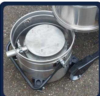
Ingresso materiale « attraversando il serbatoio », con raccordo diretto al cestello tramite collare rapido impermeabile.
