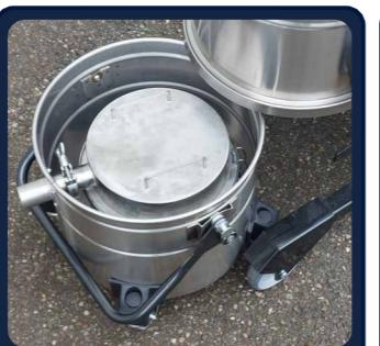
Entrada de material « atravesando el tanque », con conexión directa a la canasta mediante collar rápido impermeable.
