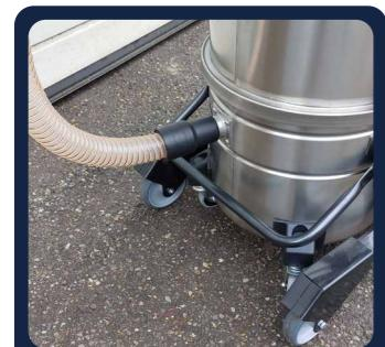
La manguera PU metálica en espiral Ø40 mm, reforzada contra la abrasión, se conecta directamente al tanque extraíble.
