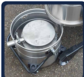
Entrée matière « traversant la cuve », avec raccord direct au panier par collier rapide étanche.
