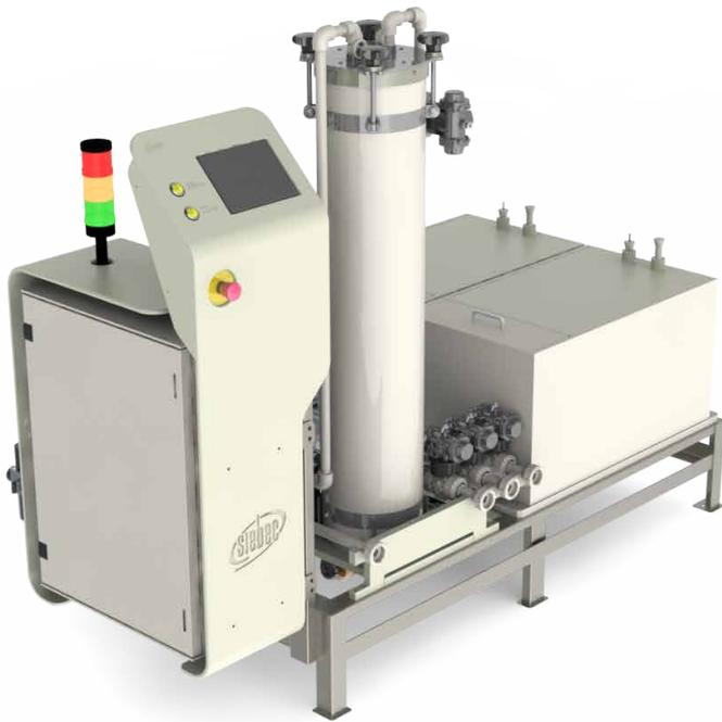
IONPURE™ permite la eliminación en continuo de los metales que contaminan los baños de cromo (III), con el fin de garantizar las condiciones óptimas y una calidad constante en el cromado.
