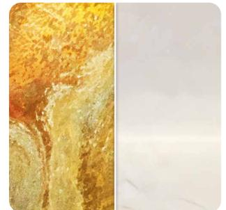
Fluide de coupe avant et après filtration par MINIPURE™
