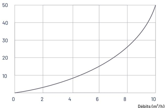
Pertes de charge initiale typique  $\Delta P$  par élément de 254mm (10"), eau à 20°C, viscosité 1cP.
