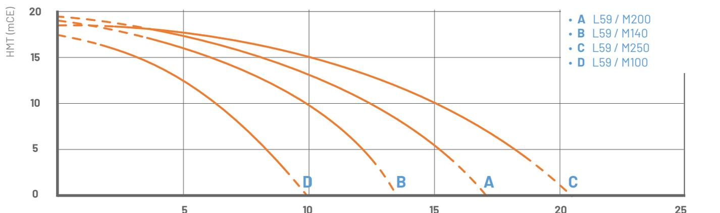
\*Débits mesurés sur 2 cartouches LTECH, avec de l'eau à 20°C. Débits variables en fonction de l'ensemble filtrant.
