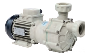
Pompe magnétique M35 auto-amorçante ~ 0.18 kW, ~ 3000 l/h
